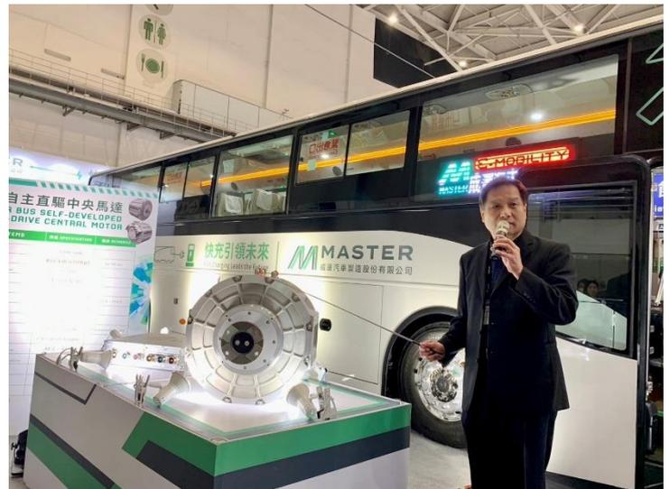
▲成運汽車總經理吳忠錫介紹成運自主研发的600hp(450kw)高功率直驅中央馬達，以及搭載218kWh電池容量的長途城際型快充電巴。
